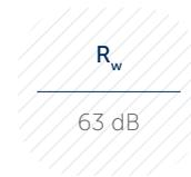
\* Mesures conformes à la norme NBN EN ISO 10140-2:2010.
