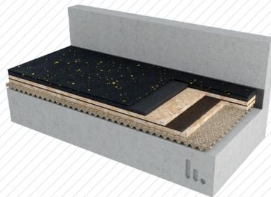
**!** Si le système de plancher flottant Stravigym est d'une hauteur différente de la structure environnante, un profilé de bordure sera nécessaire. Si un profilé de bordure rigide est utilisé, assurez-vous que sa hauteur est inférieure à la hauteur totale du système de plancher afin qu'il n'entre pas en contact avec le plancher support après la déflexion du système (1 > déflexion + fluage).
