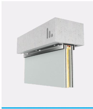
Stravilink RHD est un détail de désolidarisation en tête de mur qui permet d'isoler la connexion de tête d'un mur sec ou humide de la construction située au-dessus tout en assurant une retenue latérale.
